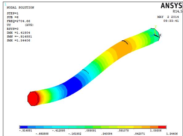
Fig.7 3<sup>rd</sup> Mode ( $e_1=0.25$ ,  $a_1/d=0.1$ ,  $e_2=0.55$ ,  $a_2/d=0.1$ )
