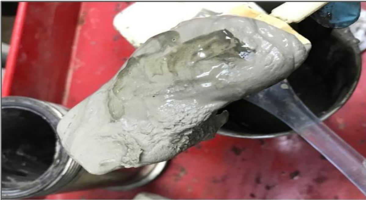
Fig. 5.Barite sagging due to low LSRV
