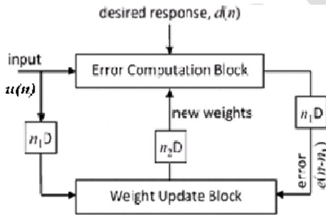
**FIGURE 2 DLMS ADAPTIVE FILTER**
